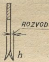
8. Názvy hlavních částí a rozměrů pilových listů ( a ); b - \alpha úhel hřbetu, \beta úhel břitu, \gamma úhel čela, \delta úhel řezu; c - trojúhelníkovité ozubení souměrné; d - trojúhelníkovité ozubení nesouměrné; e - hoblovací ozubení se dvěma řezacími zuby; f - hoblovací ozubení se čtyřmi řezacími zuby; g - drážkovací ozubení; h - rozvod zubů.
