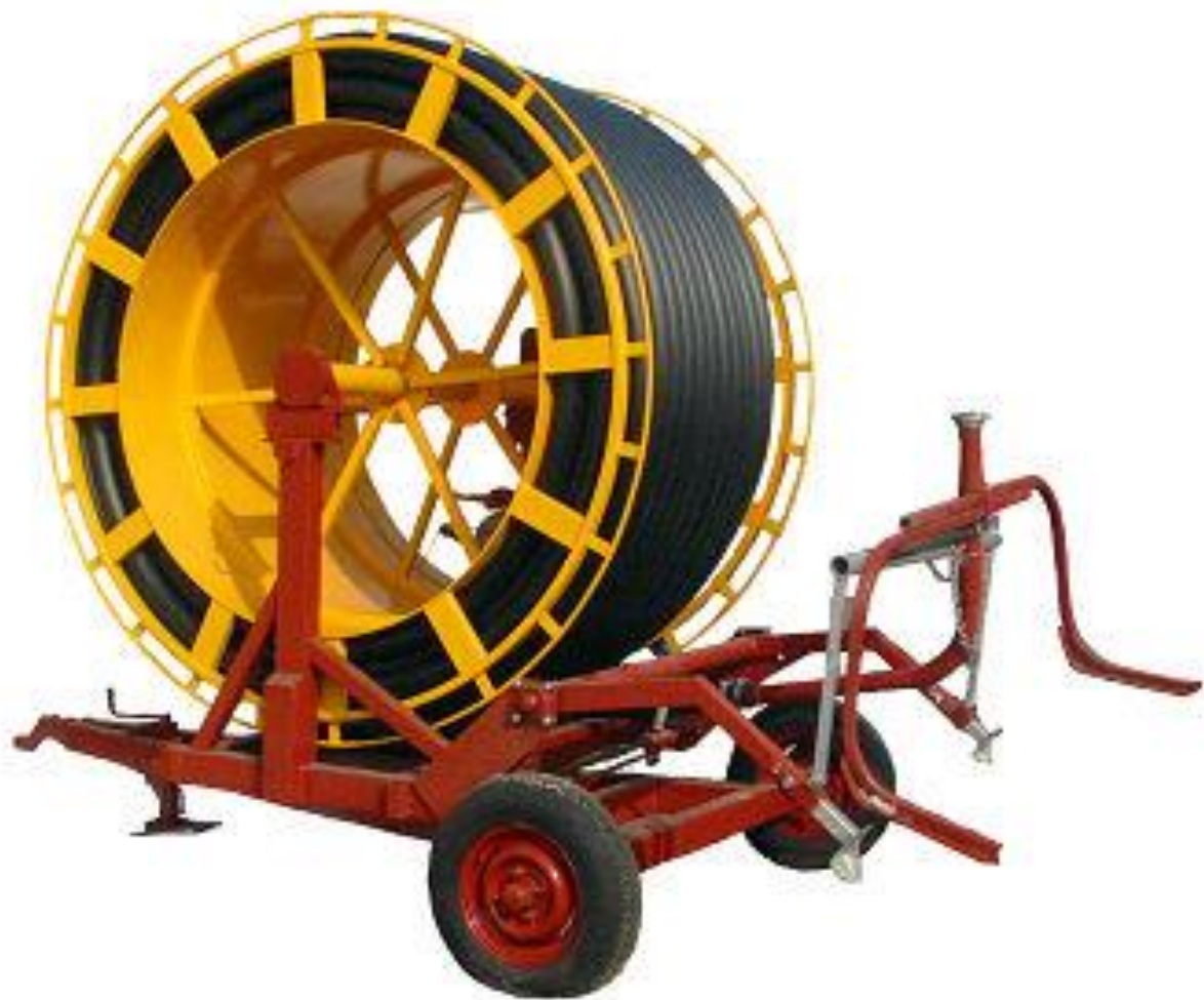
Cívkový zavlažovač ODRA R 90 – vyrábí Aquaindustrial Olomouc – průměr hadice 9 cm, délka hadice 300 m.
