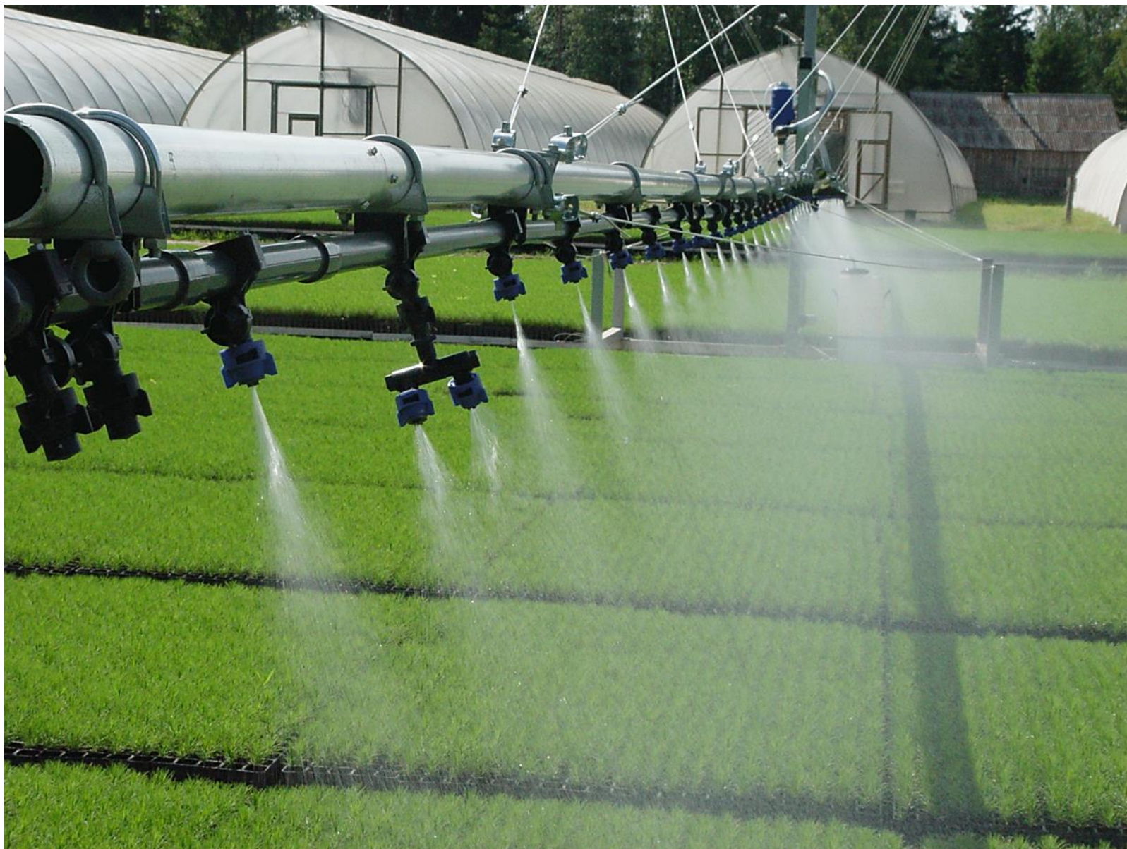
Mostové horizontální závlahy = k závlaze obalovaného sadebního materiálu pěstovaného na vzduchovém polštáři.
