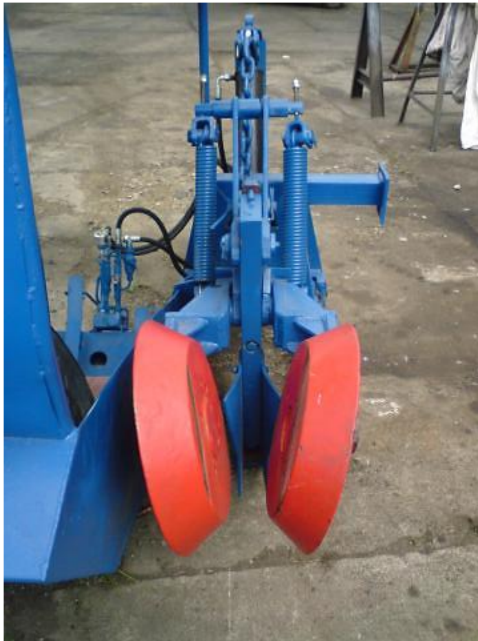
Rýhový zalesňovací stroj – RZS-2 – detail sázecí radlice.
