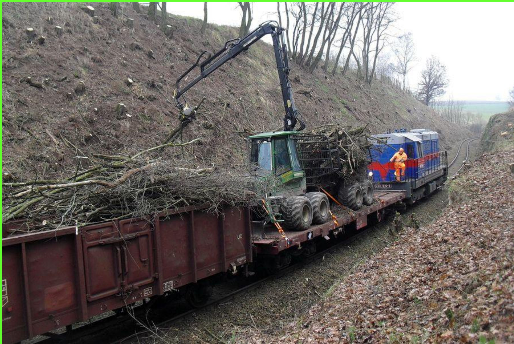
Vyvážecí traktor v nestandardní situaci při odstraňování klestu ze svahů u železniční trati.
