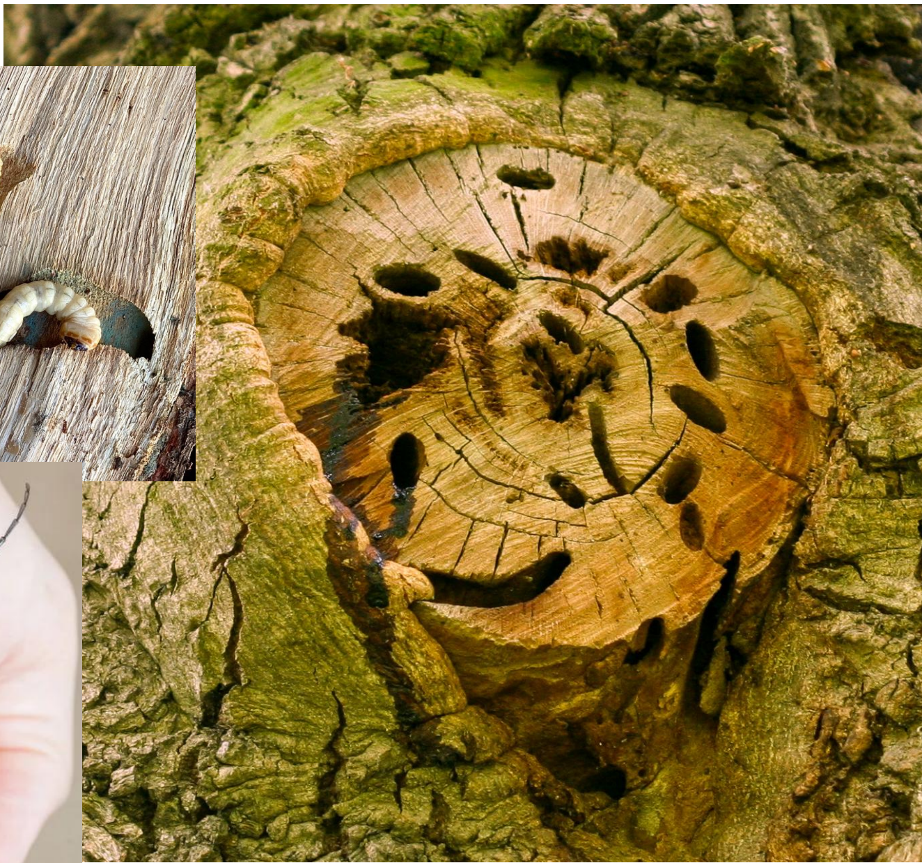
Požerky tesaříka obrovského – příklad hlubokého poškození dřeva hmyzem
