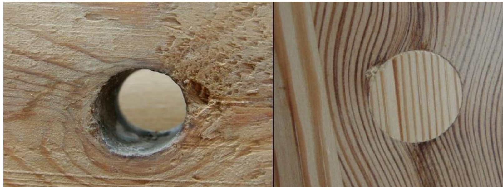
vypadavý (odumřelý, nedrží ve dřevě) – otvor po suku a zátka
