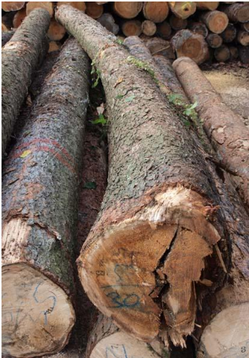
Křivost jednoduchá – jeden ohyb výřezu
