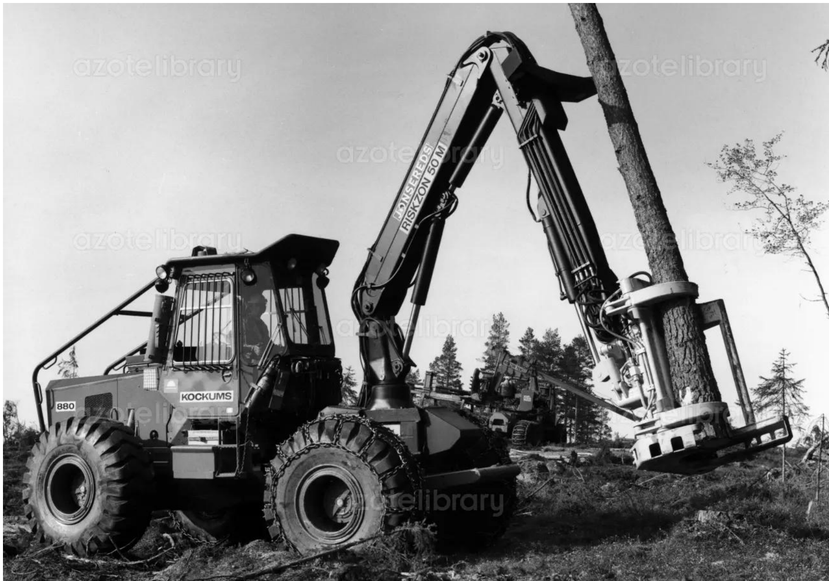
Kácecí stroj Kockums 880 (70. léta 20. století) – příklad jednooperačního stroje. Řezací ústrojí bylo řetězové a maximální průměr káceného stromu byl 58 cm. Průměrný hodinový výkon činil 60 stromů.
