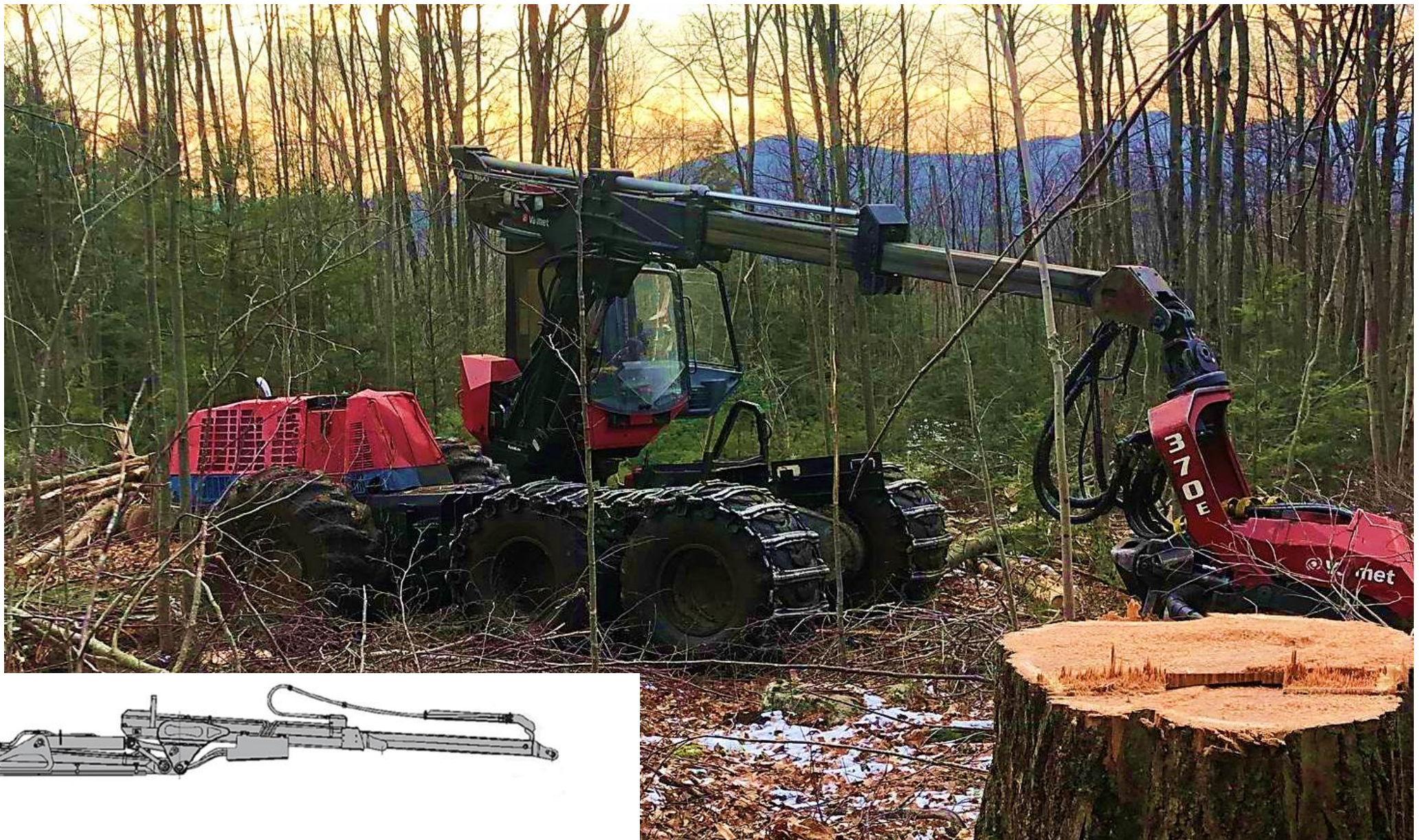
Harvestor Valmet 921 s teleskopickým jeřábem
