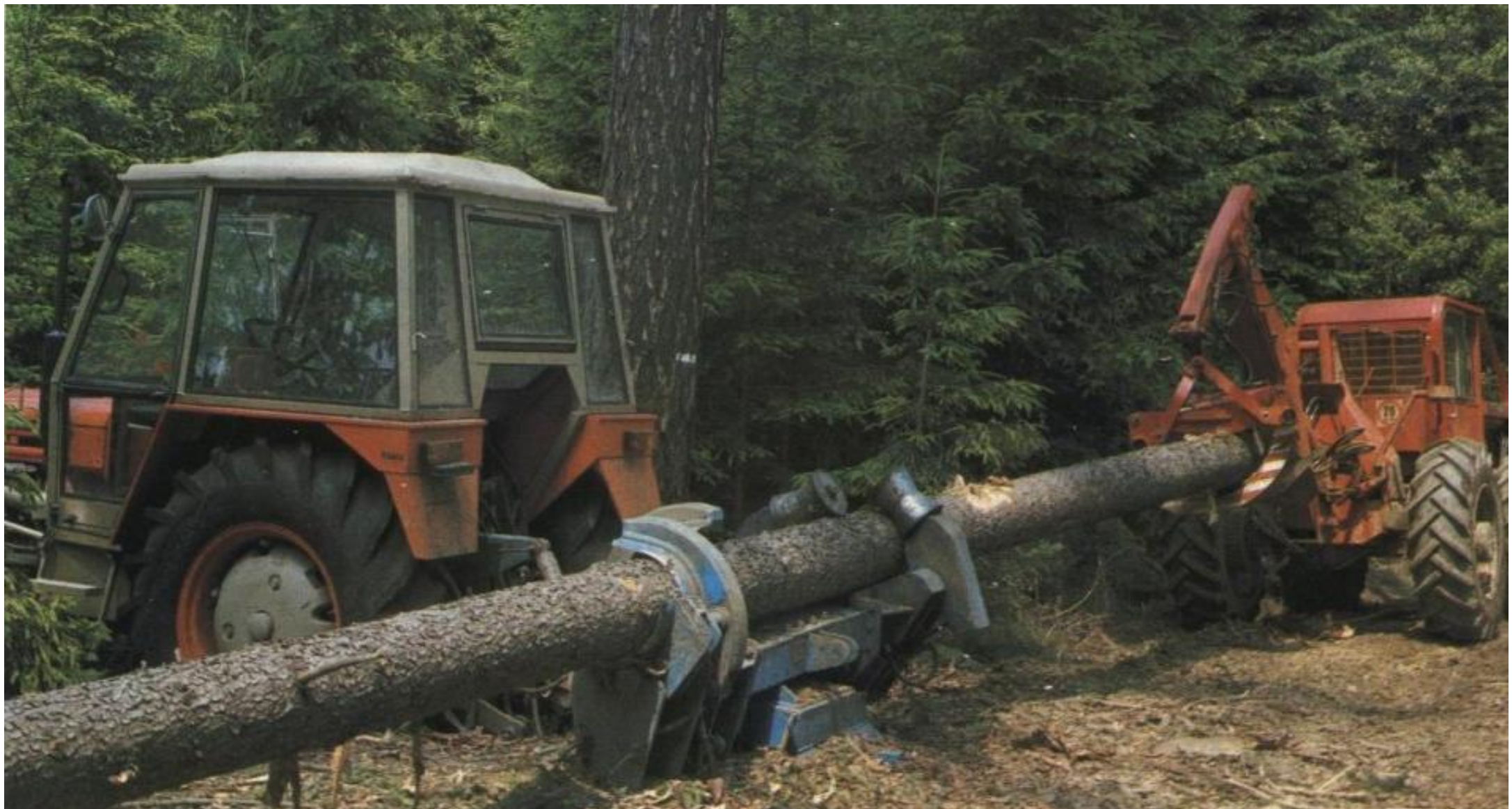
Odvětfování stromů protahovacím odvětovacím strojem OVP 1 a LKT 80 – 80. léta 20. století. Kmen byl drapákem vložen do vodících válců a odvětvovačích nožů. Kvalita odvětfování odpovídala tehdejší platné normě.
