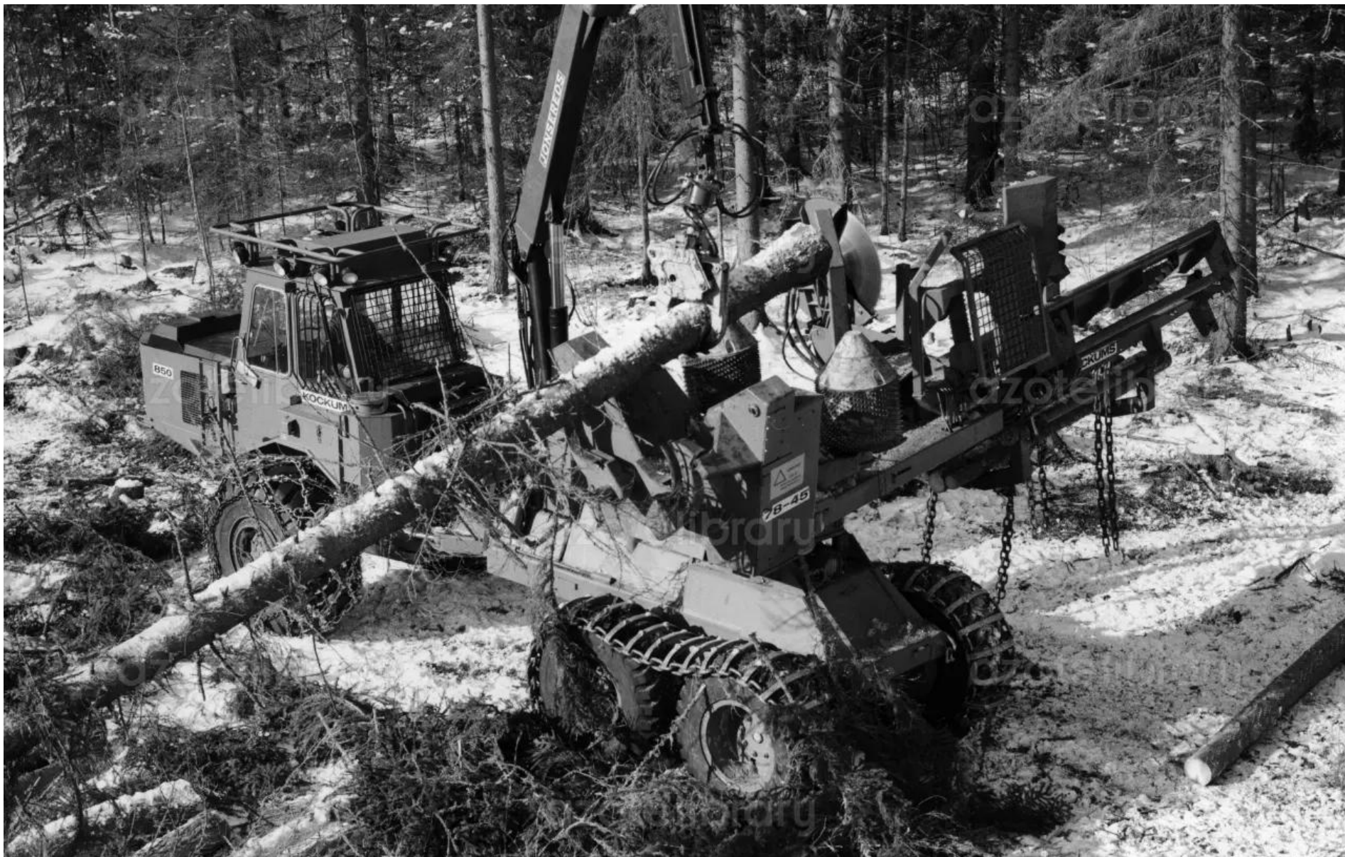
Dvoufázový procesor Kockums 850 78-45 (70. léta 20. století) - zpracovával již nějak pokácené stromy.
